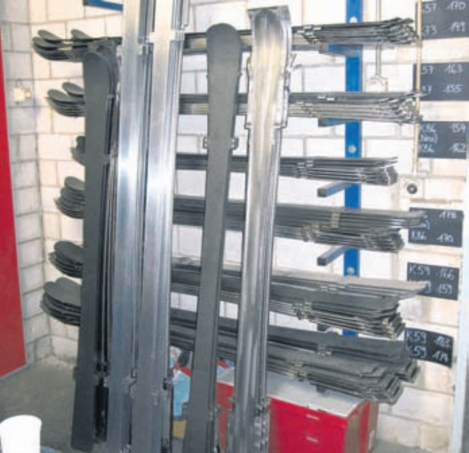
Aufwendig. Ein alter und neuer Riesenslalom-Ski (linkes Bild v.l.) und die Formen, in denen die Ski gepresst werden. Fotos eb
